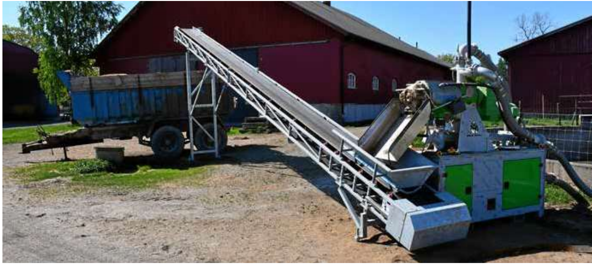
Gödseln på Nibble gård separeras med en Bauer Plug'N'Play Separator S655. En betydande del av fosfor följer med den fasta delen medan vattenlösligt kväve och kalium stannar kvar i den flytande delen.
